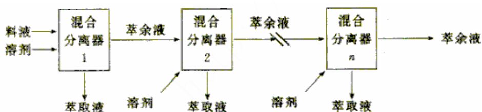
图 8-6 多级错流萃取系统
